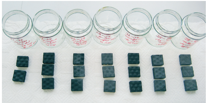
Afbeelding 2: Testmonster na zuurbestendigheidstest
